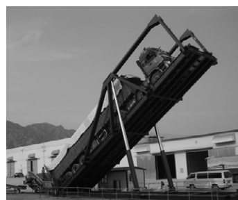
图 1 大吨位散料汽车卸车装置 (起重量 40t)
